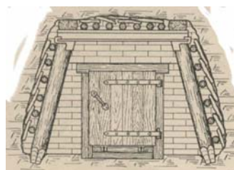
Wettertür zur Leitung der Grubenluft
