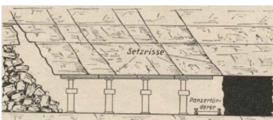
Bruchbau: Der ausgekohlte Raum geht nach Rücknahme des Ausbaues zu Bruch
